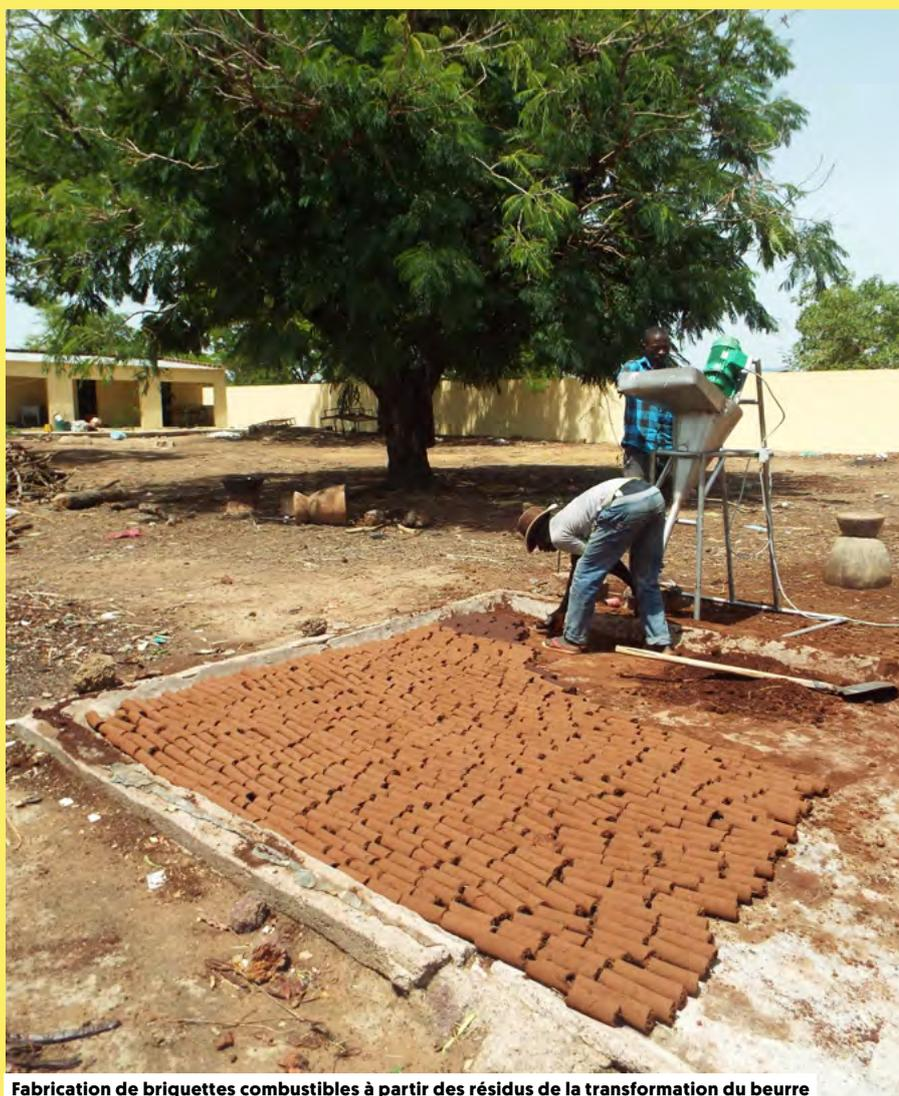
Fabrication de briquettes combustibles à partir des résidus de la transformation du beurre
